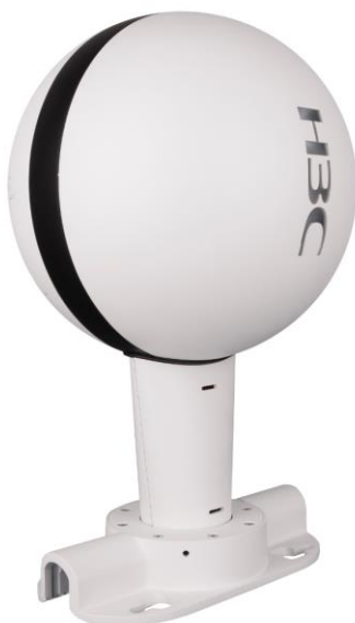
WA5600X 系列室外智能型大功率 802.11ac 无线基站接入设备
